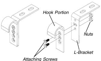
FIGURE 4 - ADJUSTING THE ANGLE OF THE BACK
